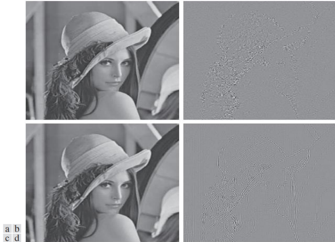
شکل ۸.۲۵ تقریب های شکل ۸.۹ (الف) با استفاده از ۱۲.۵٪ از ضرایب DCT: (الف) - (ب) نتایج کدگذاری آستانه. (ج) - (د) نتایج کدگذاری منطقه ای. مقیاس تصاویر مختلف ۴ است.
