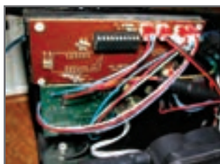
شکل ۱۳۱- برد الکترونیکی و کنترل درجه حرارت
