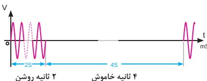
شکل ۸۴ - مشخصات سیگنال باز تاب زنگ
