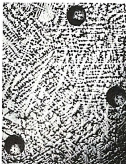
شکل ۱۱-۵: آزمایش سختی برینل. A، اثر دو ماده‌ی نرم. B، اثر دو ماده‌ی سخت تر. C، نمای میکروسکوپی از اثرات.
