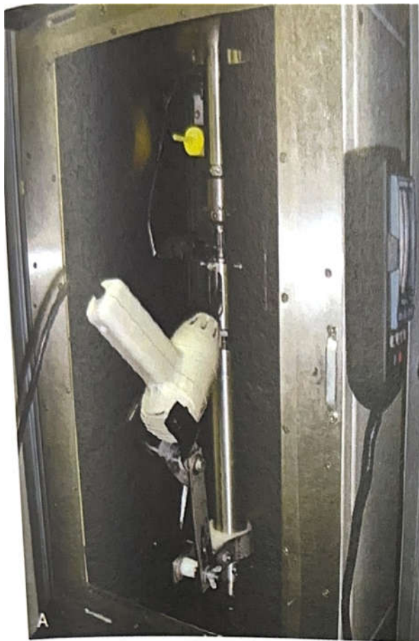
شکل ۱۹-۵: Tensilometer جهت اندازه گیری استرس پلیمریزاسیون در حین کیور شدن کامپوزیت ها. منبع نور، نمونه ی آز، اکستنسومتر برای اندازه گیری جابه جایی نشان داده شده اند.
