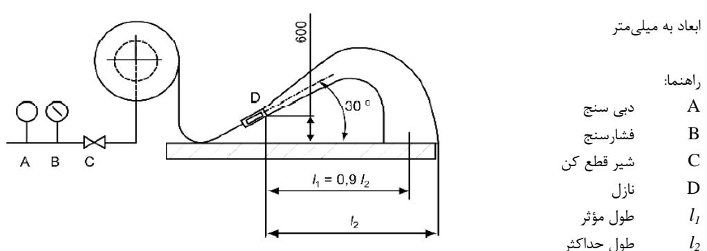
شکل ث-۴ چیدمان آزمون جهت اندازه گیری طول پرتاب
