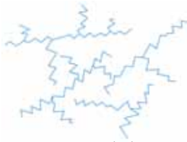
پلی (اتن) با چگالی کم که بر روی زنجیره‌ی پلیمری آن، شاخه‌های فرعی نامنظمی قرار دارند.
