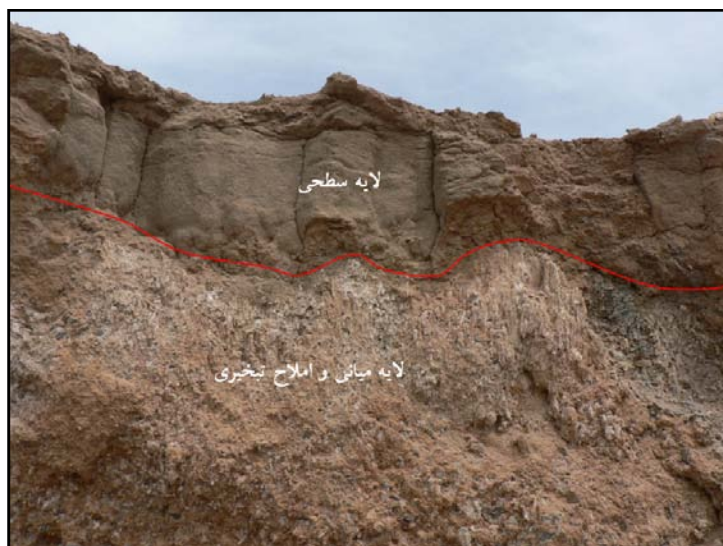
تصویر شماره (۱): نمایی از لایه ماسه ای سطحی و املاح تبخیری در لایه میانی در ترانشه خط لوله
