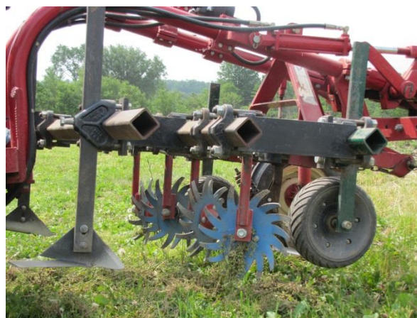
شکل ۲۹ - کولتیواتورهای مخصوص، مجهز به چرخ فشاری کف جوی و تیغه های جانبی برای افزایش نفوذ جانبی آب نسبت به نفوذ عمقی
