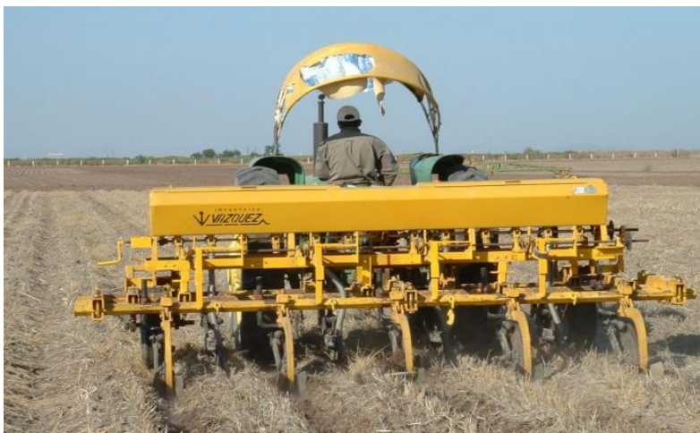
شکل ۳- شکل دادن مجدد به شیارها یا فاروهای آبیاری در سامانه بسترهای بلند بدون تخریب بسترها.
