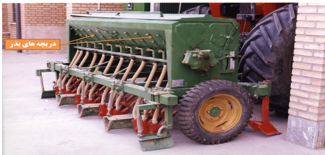
شکل ۲۳ - کور کردن دریچه بذر در خطی کار برای عدم کاشت در شیار
