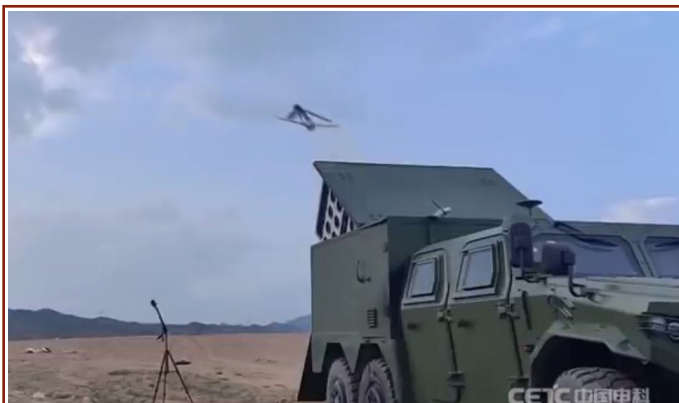
تصویری از لحظه پرتاب پهپاد توسط لانچر در آزمایش آکادمی CAEIT
