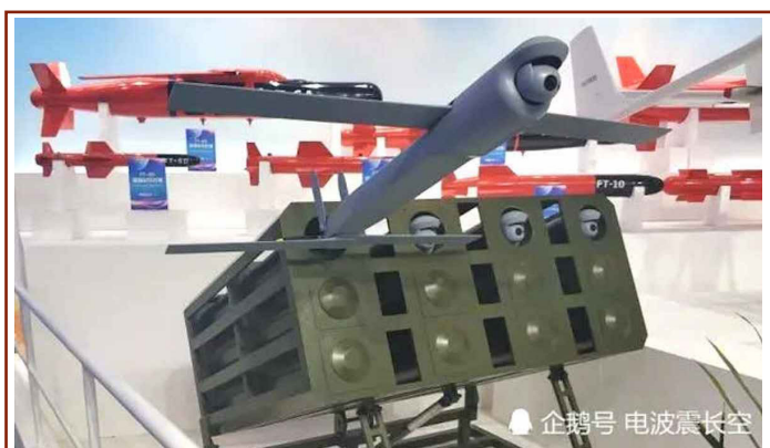
یک لانچر ۱۲ لوله‌ای برای CH-901
