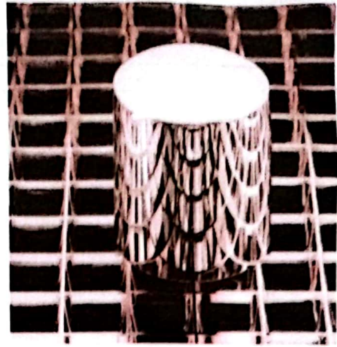
عکس ۳.۱ یکای جرم تنها یکای اساسی هنوز بر مبنای استاندارد فیزیکی است. روش حرکت در جابه‌جایی استاندارد کار مبنی بر پدیده‌های طبیعی بدون تغییر است.
