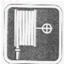
شلنگ اطفای حریق
