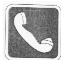
تلفن اضطراری حریق
