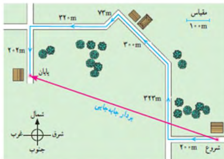
شکل ۳. پاره خط راستی که مبدأ حرکت را به مقصد حرکت وصل می کند بردار جابه جایی حرکت نامیده می شود.
