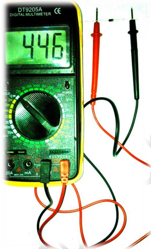
طریقه‌ی تست دیود‌ها : ابتدا باید دستگاه را از برق خارج کنیم یعنی به هیچ تغذیه‌ای در مدار روشن نباشد حتی اگر در مدار خازن‌های الکتروولیتی ولتاژ بالا یا ظرفیت بالا وجود داشت باید به کمک یک مقاومت کم اهم ( حدود 270 تا 470 اهم ) پایه‌های خازن را به یکدیگر وصل کنیم مطابق شکل زیر :
