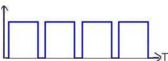
نمودار نحوه تولید ولتاژ 4 ولت با تکنیک PWM.
