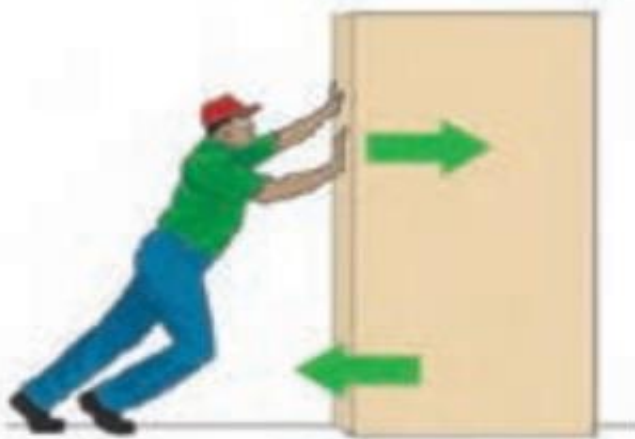
شکل ۲- شخص به جعبه ساکن نیرو وارد می‌کند ولی جعبه حرکت نمی‌کند زیرا نیروی روبه جلو با نیروی اصطکاک رو به عقب هم اندازه‌اند.
