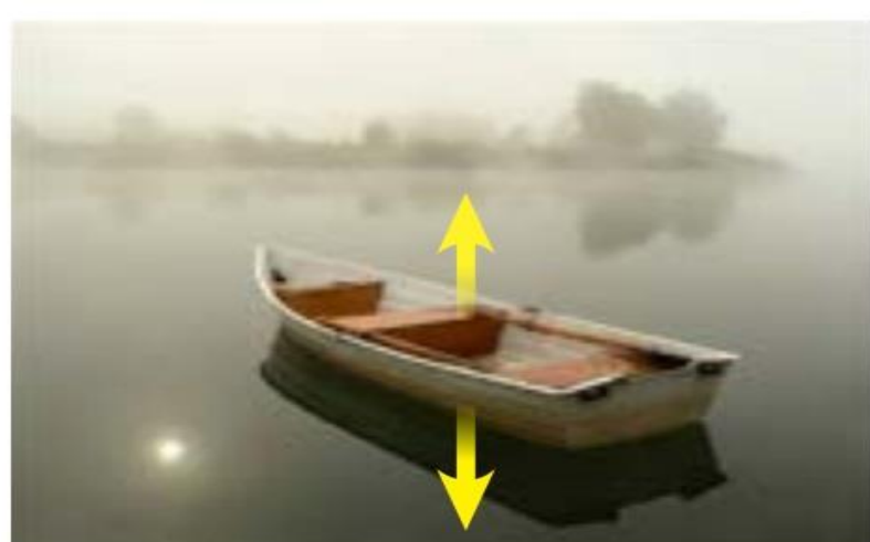
شکل ۵- نیروی رو به بالایی که از طرف آب به قایق وارد می‌شود هم اندازه با وزن قایق است، بنابراین قایق روی آب به حالت تعادل باقی می‌ماند.
