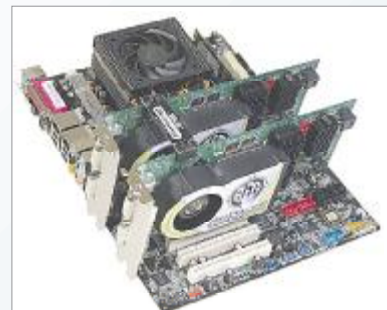
شکل ۱۴: مادربرد با دو کارت گرافیک SLI
