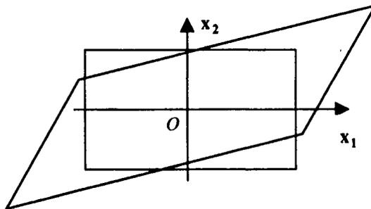
Figure 2.7. Strains when  $S_{16} \neq 0$ ,  $S_{26} \neq 0$ ,  $S_{36} \neq 0$
