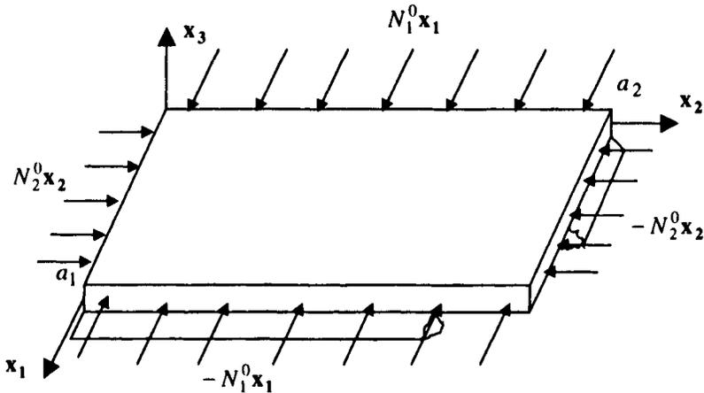
Figure 6.12. Buckling loads
