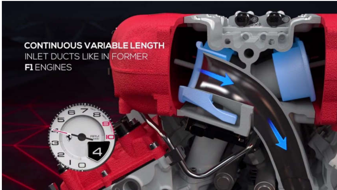
وضعیت لوله ورودی شیپوری شکل در دور موتور 4000 RPM در حالت طول کوتاه لوله مانیفولد هوای ورودی
