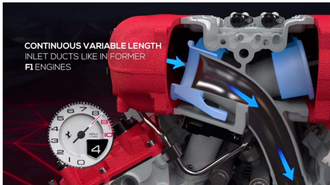
وضعیت لوله ورودی شیپوری شکل در دور موتور 8500 RPM در حالت طول بلند لوله مانیفولد هوای ورودی
