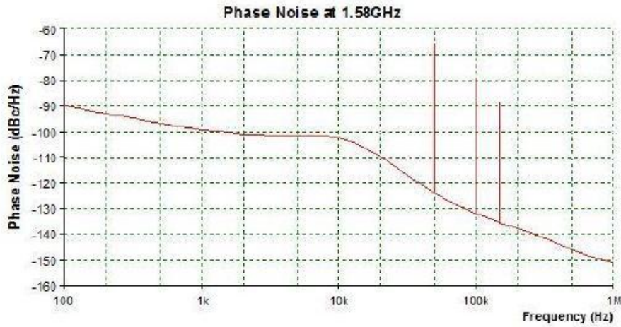
شکل ۵-۱۴: نمودار نویز فاز برای سنتزکننده سیستم GPS
