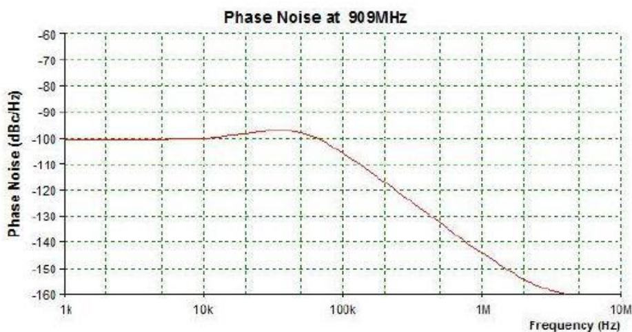
شکل ۵-۱۰: نمودار نویز فاز سنتزکننده سیستم RFID
