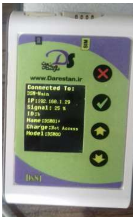
شکل (۲-۳) نمایش اتصال به DSM-MAIN و IP دستگاه متفاوت با IP نرم افزار
