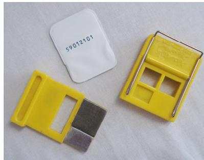
شکل ۱-۳ A: دزیمتر فیلم بچ با یک عدد فیلم دندانپزشکی در پوشش ضد نور. بچ دارای پنج بخش است: (الف) پنجره باز که پرتوهای بتا و گاما با انرژی‌های مختلف قادر به نفوذ و سیاه کردن هستند (ب) قسمت پلاستیکی نازک  $50 \text{ mg/cm}^2$  که پرتوی بتا پرانرژی قادر به نفوذ است (پ) قسمت پلاستیک ضخیم  $300 \text{ mg/cm}^2$  که پرتوهای گامای کم انرژی نفوذ نمی‌کنند. (ت) بخش فیلتر آلومنیوم با ضخامت ۱ mm (ث) بخش فیلتر  $0.3 \text{ mm Pb}$  و  $0.7 \text{ mm Sn}$
