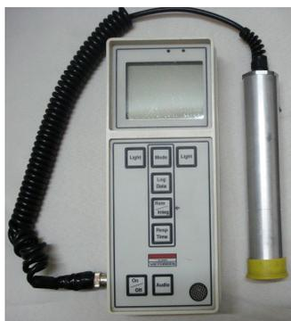
شکل ۷-۳ بررسی‌گر به همراه پروب گایگر مولر و یک حفاظ پلاستیکی برای تفکیک پرتوهای بتا و گاما به منظور مانیتورینگ محیط و دُزیمتری پرسنل ساخت شرکت ویکتورین
