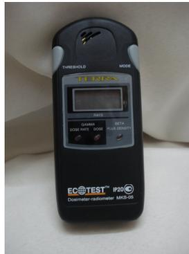
شکل ۳-۴، دزیمتر دیودی پرتوی گاما و فلومتر بتا، این ابزار قادر به نمایش دُز-ریت گاما نیز می‌باشد.
