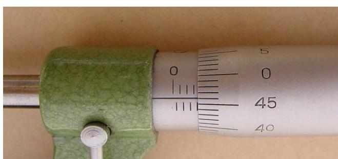
اگر پیچ یک دور بپیچد در نوع اول زباله ریزسنج نیم میلیمتر جابجا می‌شود بنابراین وقتی پیچ به اندازه یک درجه بپیچد دهانه ریزسنج به اندازه یک صدم میلیمتر باز یا بسته می‌شود بنابراین با استفاده از ریزسنج دقیق‌تر اندازه گیری تا میلیمتر بالا می‌رود.
