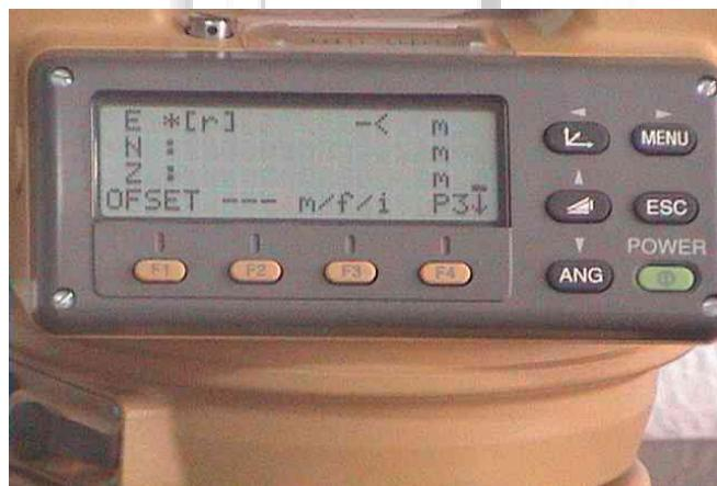
**کلید F1** جهت اندازه گیری مختصات به روشهای انحرافی است
