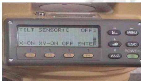
کلید F1 جهت تنظیم کمپانزاتور در یک جهت
