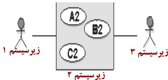
برای تشریح مورد های استفاده در سیستم اصلی می توان چگونگی برقراری ارتباط در بین زیر سیستمها را مشخص نمود. برای نمونه در شکل ۲-۱۹ برای نمایش چگونگی عملکرد مورد استفاده A چگونگی برقراری ارتباط در بین زیر سیستمهای آن مشخص شده است. در واقع خطوط افقی بیانگر بندهای سناریو برای مورد استفاده هستند. دیاگرام زیر مشخص می کند در جهت ارائه سرویس A چگونه زیر سیستمها با یکدیگر مرتبط می شوند.
