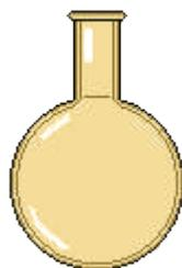
**کاربرد:** از بالن تقطیر، علاوه بر تقطیر مایع ها، می توان در تهیه آب مقطر، تهیه اتیلن (آبگیری از الکل) تهیه گازهای استیلن، هیدروژن، کلر، دی اکسید گوگرد، دی اکسید کربن و غیره استفاده کرد.
