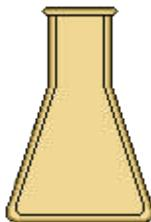
**کاربرد:** ارلن ممکن است ساده یا مدرج باشد. از نوع مدرج آن برای برداشتن حجم معینی از مایع یا تعیین تقریبی حجم مایع استفاده می شود اما نوع ساده آن برای استفاده از کارهای گوناگون مانند گرم کردن مایع ها است. افزون بر آن یک نوع از ارلن دارای لوله جانبی است و به ارلن تخلیه موسوم است، برای صاف کردن با خلأ و نیز تهیه مواد گازی و غیره استفاده می شود.
