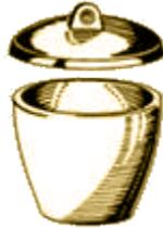
**کاربرد:** از بوته در آزمایشگاه معمولی برای اندازه گیری آب تبلور کات کبود یا سولفات مس زاج سبز یا سولفات آهنو نمک قلیا یا کربنات سدیم به فرمول و همچنین برای ذوب قند، پارافین جامد و ... استفاده می شود. چون بوته چینی در برابر گرما (تا حدود ۱۲۰۰C) مقاوم است، از آن در آزمایشگاه های شیمی تجزیه برای خشک کردن رسوب کردن رسوب و پختن رسوب در کوره الکتریکی استفاده می شود.
