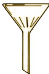
**کاربرد:** از قیف برای انتقال محلول از ظرفی به ظرف دیگر استفاده می شود (به عنوان مثال برای انتقال محلول از ظرفی به بورت، استوانه مدرج، بالن پیمانه ای، قیف شیردار، ارلن و... از قیف استفاده می شود) برای این کار، محلول موردنظر را نخست در بشر ریخته سپس به کمک قیف تمیز به ظرف دلخواه منتقل می شود.
