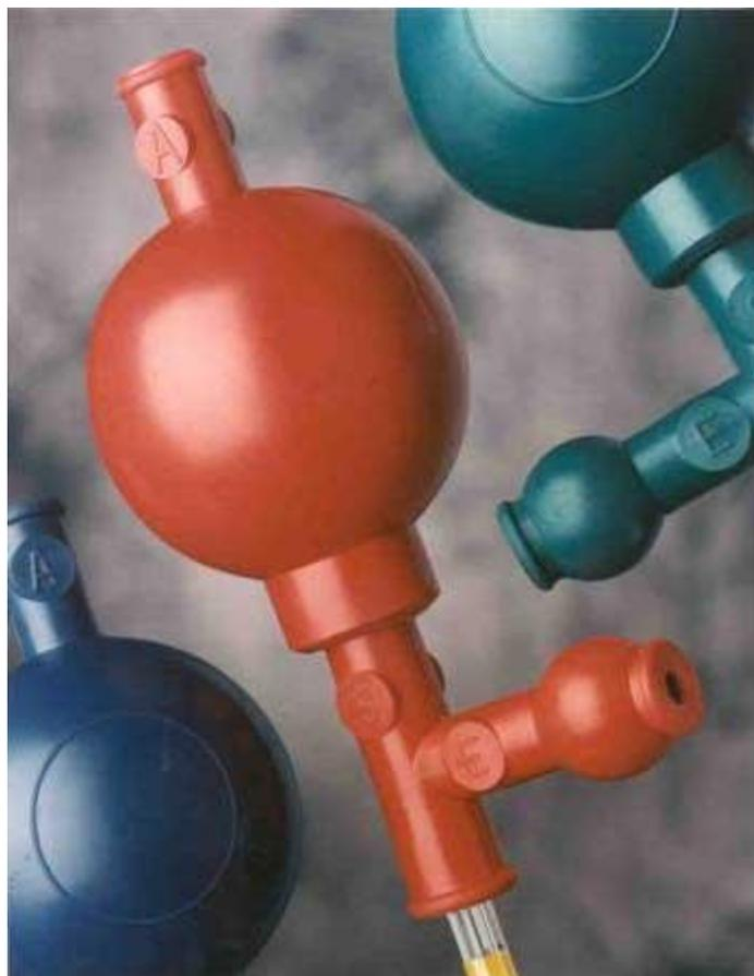
**طرز استفاده:** دکمه A برای خالی کردن هوای داخل پووار است. دکمه B برای مکش مواد سمی است. دکمه E برای خالی کردن مواد مکش شده است.
