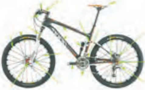
شکل ۳ - دوچرخه از اجزا یا ماشین‌های ساده‌تری مانند: اهرم، پیچ و مهره، چرخ و محور، چرخ و دنده ... تشکیل شده است.
