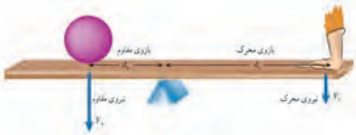
شکل ۱۱ - شکل اهرم که در آن بازوی محرک، نیروی محرک، بازوی مقاوم و نیروی مقاوم نشان داده شده است.
