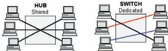
شکل ۱-۱۵- تفاوت اشتراک‌گذاری اطلاعات در Hub و Switch
