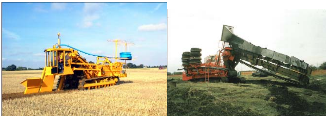
شکل شماره ۱- نمونه‌هایی از ترنچر چرخ زنجیری در حال حفاری
