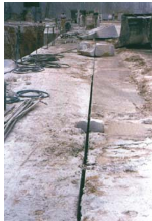
شکل ۳-۱۷-۶- برش ایجاد شده توسط سیم برش الماسه
