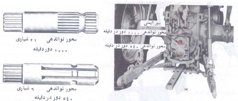
شکل ۶-۱-۷- نحوه اتصال محور تواندهی به تراکتور
