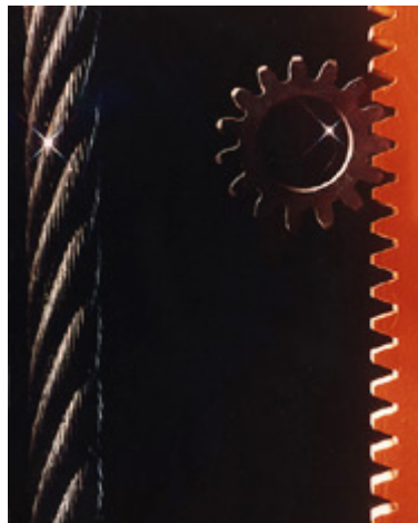
شکل ۴-۱۰-۳- نوع حرکت بالابر در طول دکل به وسیله استفاده از سیستم دندانه و شانه‌ای
