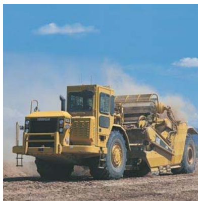
شکل ۲-۶-۹- اسکرپرهای نقاله‌دار و تعیین ظرفیت آنها
