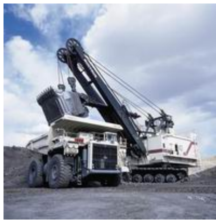
شکل ۳-۱۹-۳- شاول در حال عملیات کپه برداری
