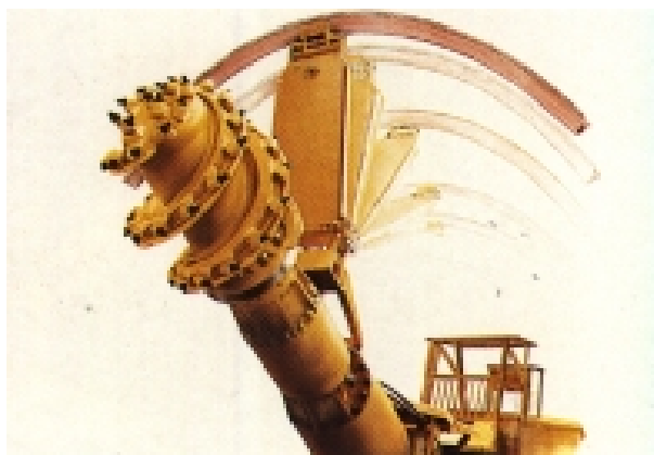
شکل ۳-۱۶-۷- ماشین رودهدر به همراه تجهیزات نصب قاب
