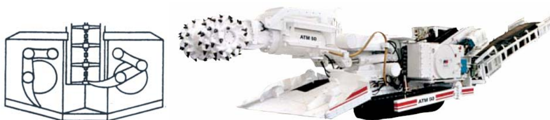
شکل ۳-۱۶-۱۳- ماشین رودهدر با دو بازوی گاز انبری خرچنگی
