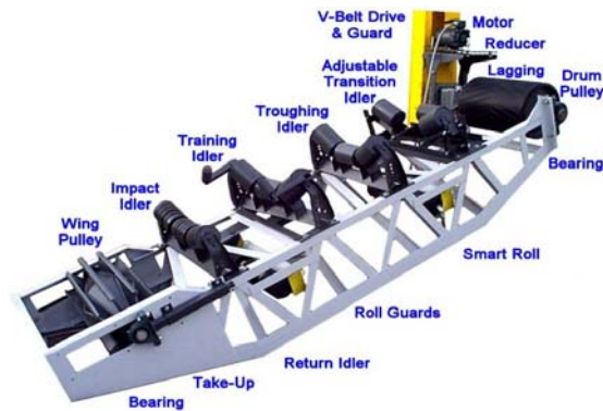
شکل ۶-۴-۴- دو نمای کلی از تجهیزات نوارنقاله
