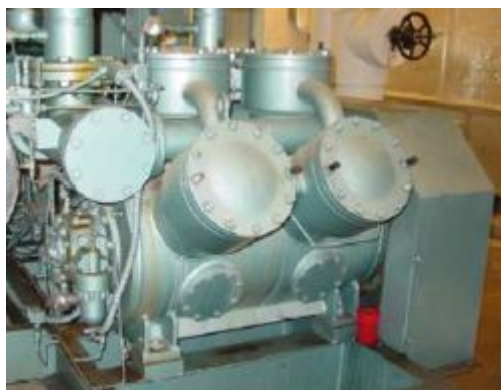
شکل ۶-۱۲-۱۰- نمونه یک کمپرسور ثابت رفت و برگشتی که با نیروی محرکه موتور دیزل کار کرده و دارای ۶ سیلندر می‌باشد.
