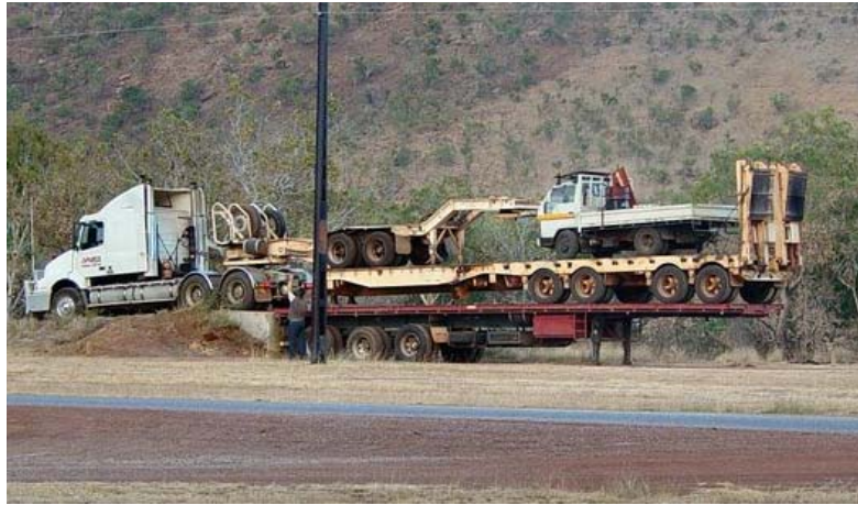
شکل ۶-۳-۱۰- کشنده در حال بار کردن کفی دارای شترگلو بر روی تریلی معمولی
