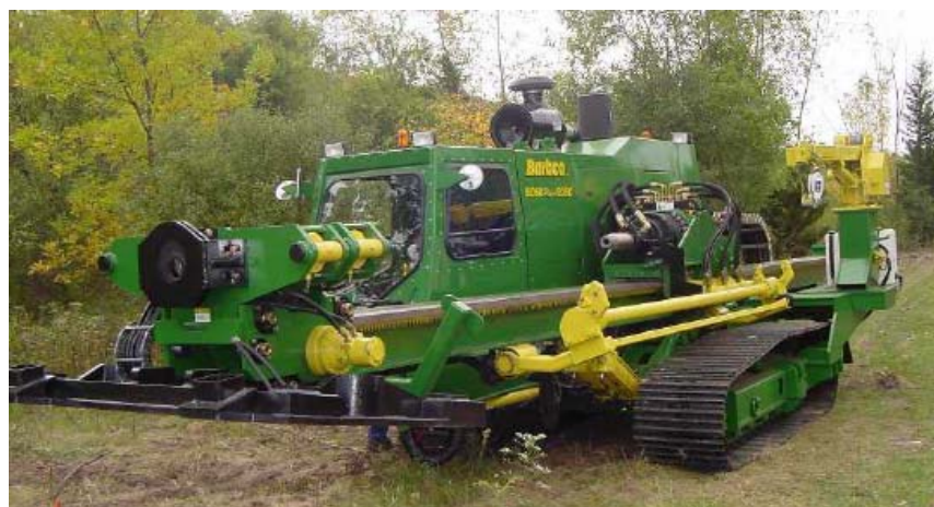
شکل ۳-۲۹-۱۳- دستگاه حفاری چالهای افقی
