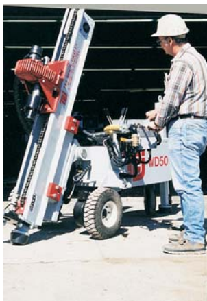
شکل ۳-۱۵-۴- دریل واگن چرخ لاستیکی ساخت شرکت TEI جدول ۳-۱۵-۱- مشخصات فنی دریل واگن نوع چرخ لاستیکی
