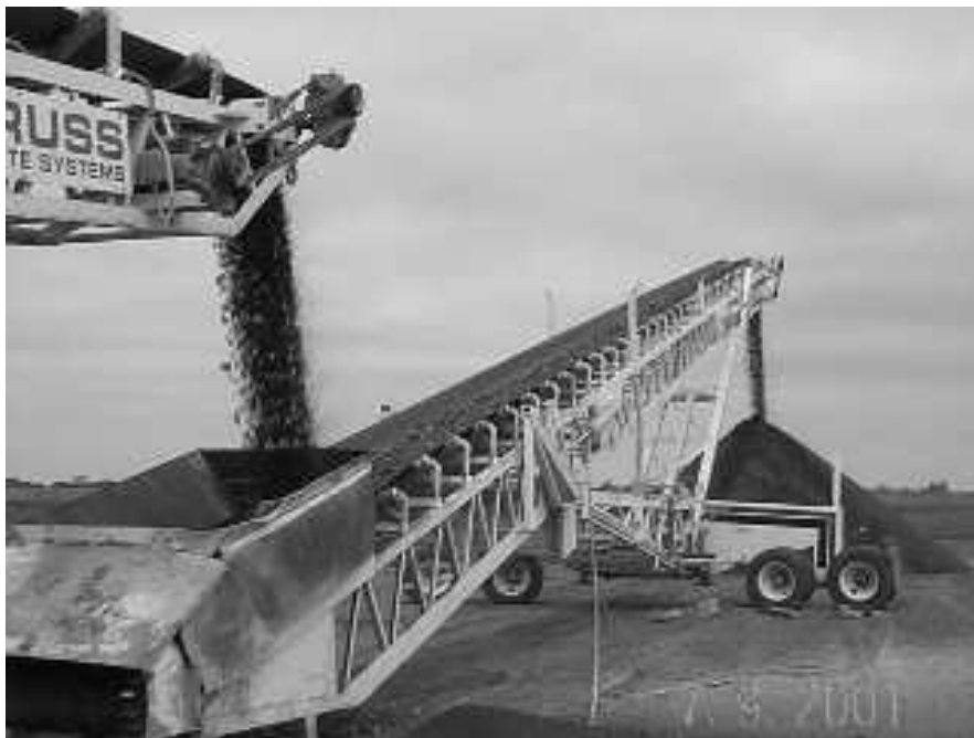
شکل ۴-۱۴-۳- تسمه نقاله‌ها سنگدانه‌های حاصل از بازیافت را به محل دپو منتقل می‌کنند
