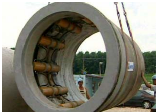
شکل ۵-۱۰-۴- لوله بتنی مخصوص عملیات لوله رانی
