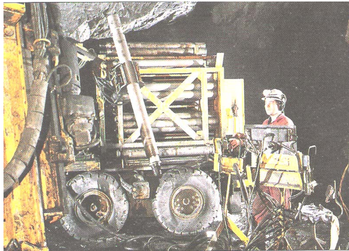
شکل ۳-۱۸-۵- نمایش سیستم جایجایی اتوماتیک لوله‌های حفاری
