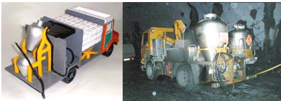
شکل ۳-۲۸-۸. نمونه دستگاه انفوشارژر، نصب شده روی کامیون
