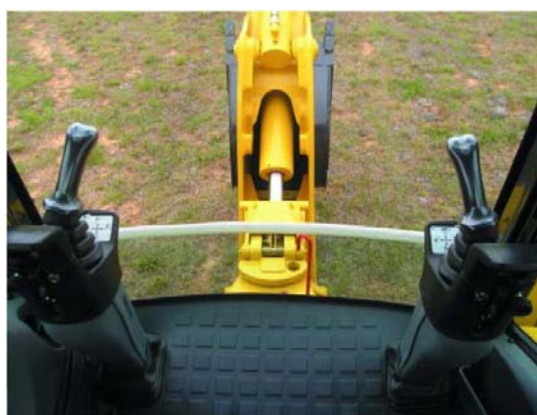
شکل شماره ۲-۹-۹- دستکهای کنترل کننده بیل مکانیکی
