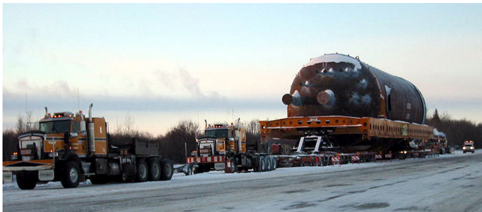
شکل ۳-۲-۶- استفاده از چند کشنده برای حمل بوژی
