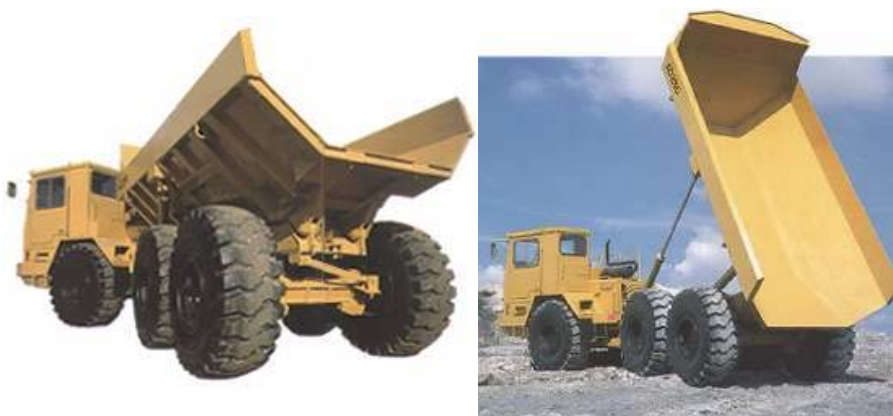
شکل ۲-۷-۵- کامیون کمرشکن در حال تخلیه
