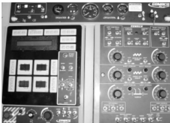
شکل ۴-۱۶-۱۴- نمونه ای از صفحه کنترل فینیشر
