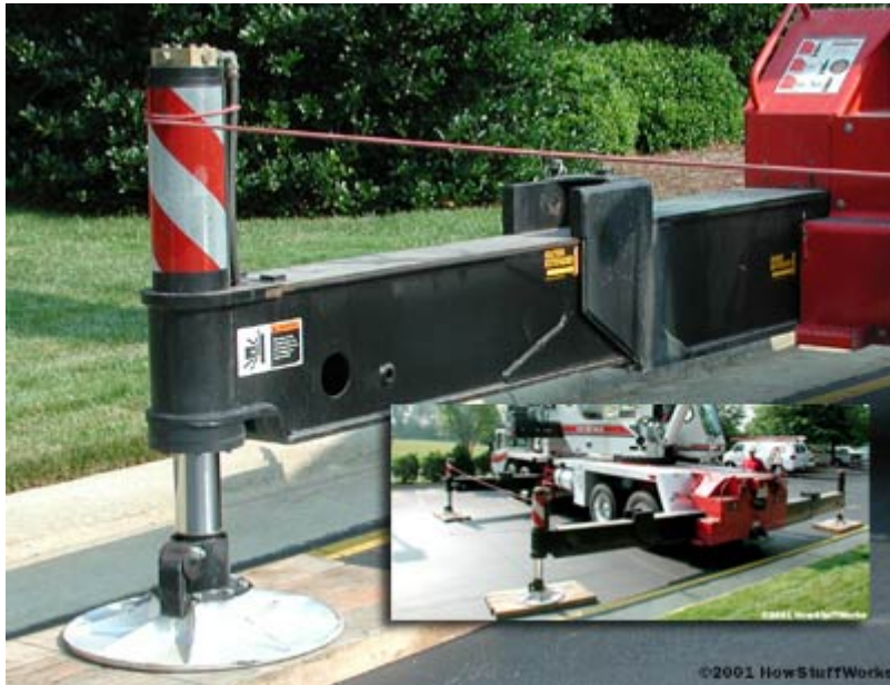
شکل ۶-۷-۷- جک (Outtrigger) در جرثقیلهای چرخ لاستیکی
