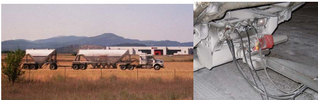
شکل ۶-۳-۷- اتصال تریلی به واحد کشنده به کمک دالی
