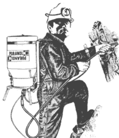
شکل ۳-۲۸-۱۲. نمونه آنفوشارژر قابل حمل به صورت انفرادی
