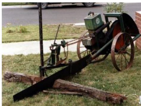
شکل ۶-۱۵-۲-اره های قدیمی با حرکت رفت و برگشتی تیغه اره
