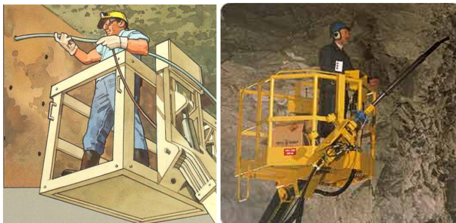
شکل ۳-۲۸-۱۱ خرجگذاری از داخل سبد دستگاه آنفوشارژر
