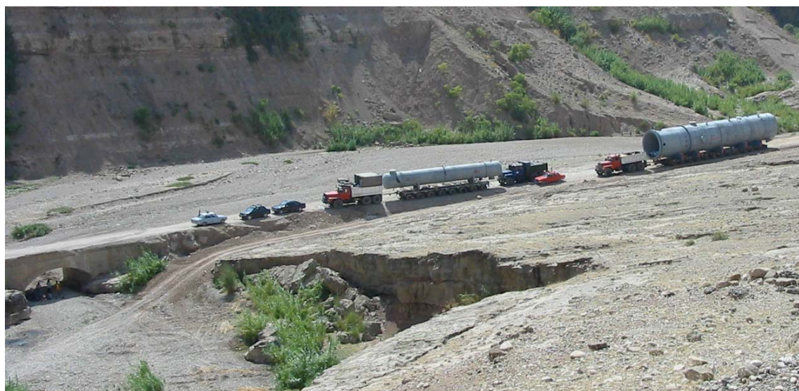
شکل ۶-۲-۱۰- عبور بوژی از کنار گذر پل
