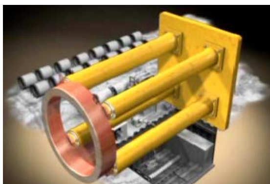
شکل ۵-۱۰-۸- سیستم جک زنی
