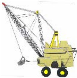
شکل شماره ۳-۱۲-۲- دراگلاین با شناسی چرخ لاستیکی
