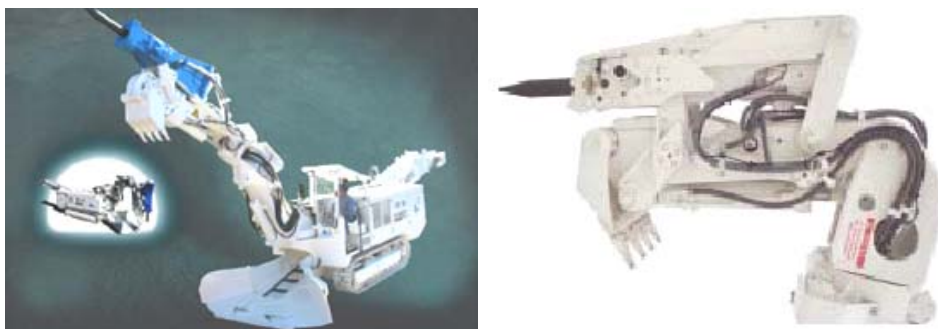
شکل ۳-۱۰-۹- نمایی از ماشینهای چکش هیدرولیکی به همراه سیستم بارگیری
