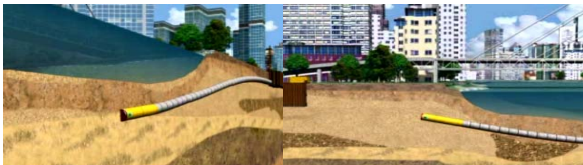
شکل ۵-۱۰-۲- نمایش مسیر لوله رانی از زیر رودخانه
