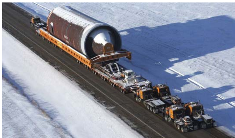
شکل ۴-۲-۶- استفاده از چهار کشنده در عقب محموله برای حفظ تعادل بوژی
