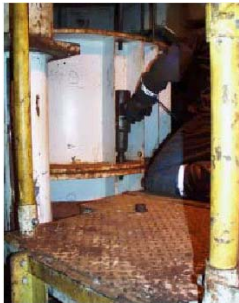
شکل ۳-۲۲-۱۵- نمایش اتصال کیسینگ‌ها به وسیله بولت
