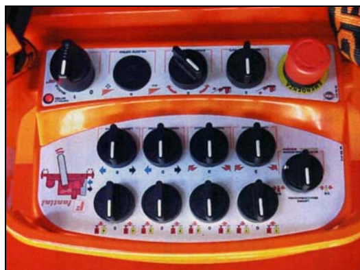
شکل ۳-۲۷-۱۲- تابلوی کنترل ماشین‌هاواژ
