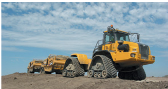
شکل ۲-۶-۱۰- استفاده همزمان از چند اسکرپر
