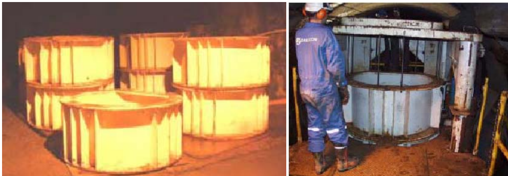
شکل ۳-۲۲-۱۴- نمایی از کیسینگ‌های استاندارد به طول ۸۰ سانتیمتر
