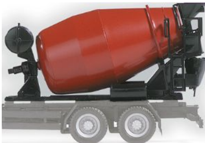
شکل شماره ۳-۹-۴- میکسر متداول تخلیه از عقب روی شاسی کامیون
