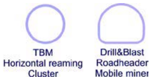
شکل ۳-۲۳-۴- مقاطع قابل حفاری با انواع ماشین‌های حفاری
