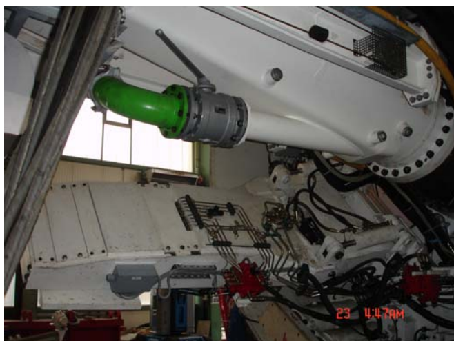
شکل ۳-۳-۲۳. بازوی جایگذاری سگمنتهای بتنی
