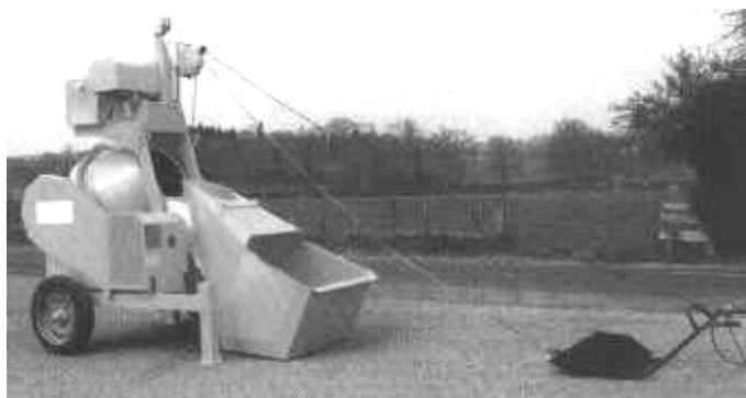
شکل ۴-۱۳-۹- بتونیر مجهز به درگ لاین
