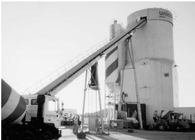
شکل ۴-۴-۲- تسمه نقاله بزرگ برای تغذیه بچینگ
