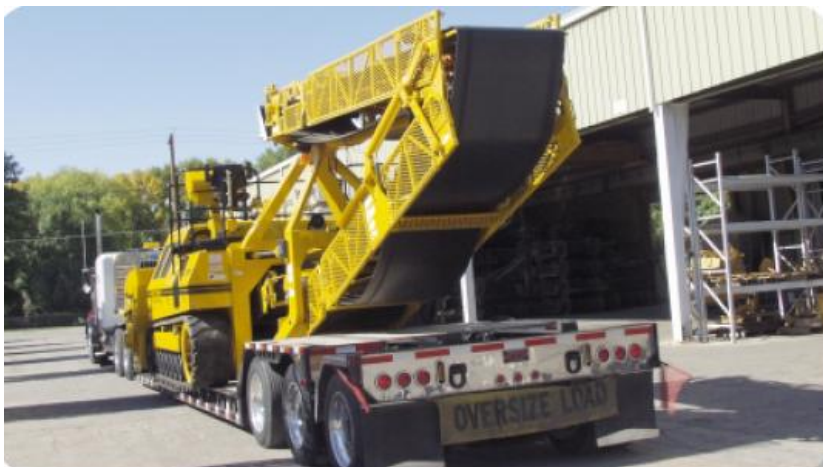
شکل شماره ۲-۱۸-۸- نحوه حمل و نقل تریمر آسفالتی
