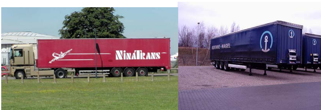
شکل ۶-۳-۶- نمایش نیمه تریلی در حالت بسته شده به کشنده و جدا
