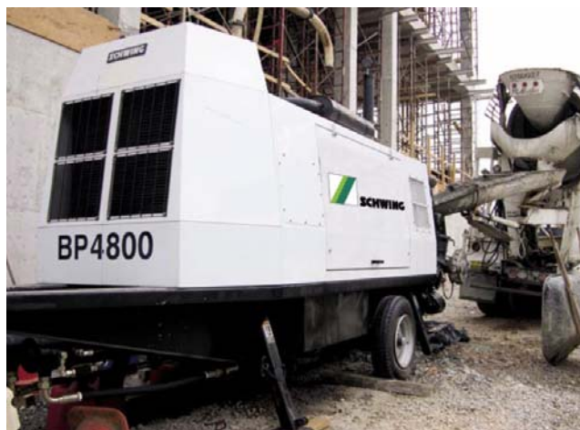
شکل ۴-۱۰-۴- پمپ بتن کارگاهی (زمینی)
