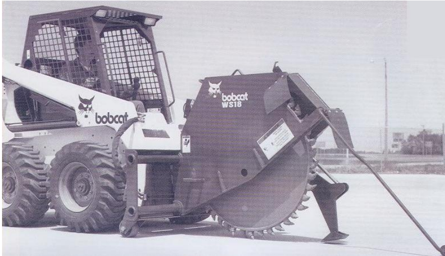
شکل ۲-۱۴-۲- بابکت تجهیز شده برای برش آسفالت
