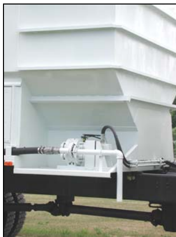
شکل ۳-۲۱-۱۳- پمپ انتقال گازوئیل
