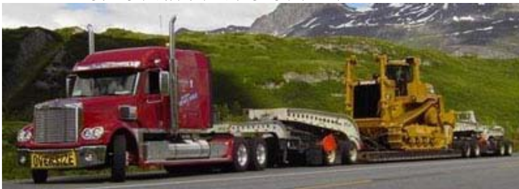
شکل ۶-۳-۱۱- حمل بلدوزر با کفی دارای شترگلو
