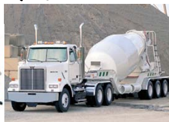
شکل شماره ۴-۹-۴- میکسرهای تخلیه از عقب بر روی شاسی‌های مختلف (تریلی، کامیونی ۴ محور، کارگاهی)
