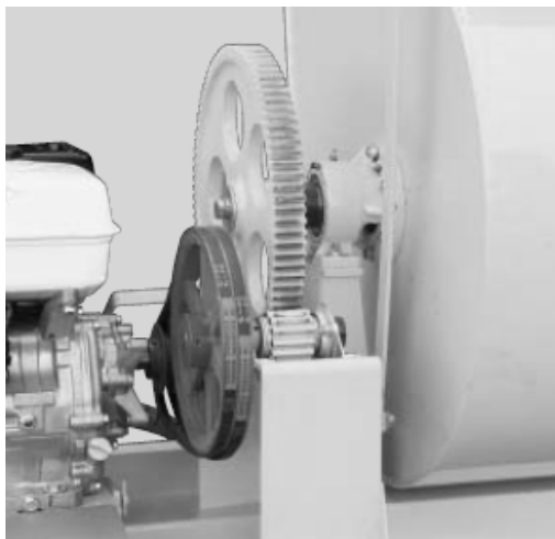
شکل ۴-۱۳-۷- انتقال نیرو توسط چرخدنده‌ها
