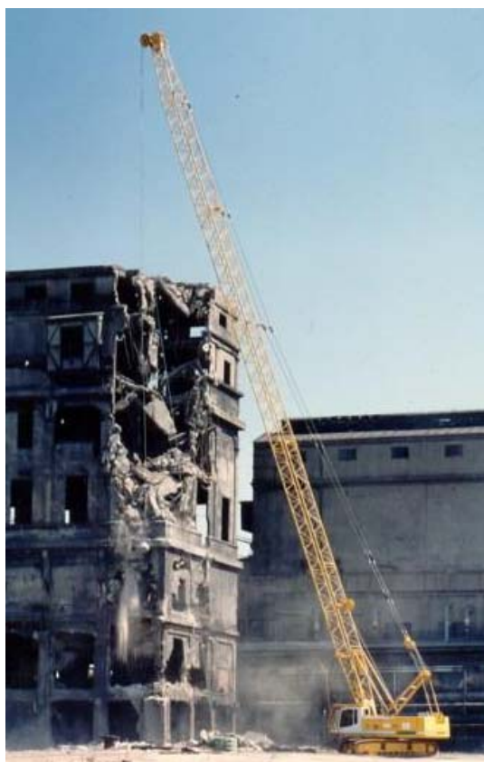
شکل ۶-۷-۱۱- برخی از کاربردهای جرثقیل چرخ زنجیری بوم شبکه‌ای سبک
