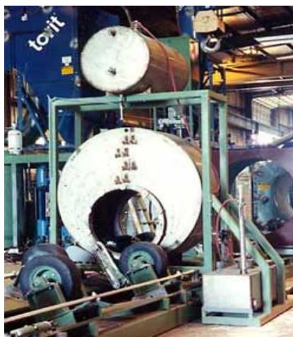
شکل ۵-۴-۱۰- سیستم پوشش دهی خارجی چند لایه
