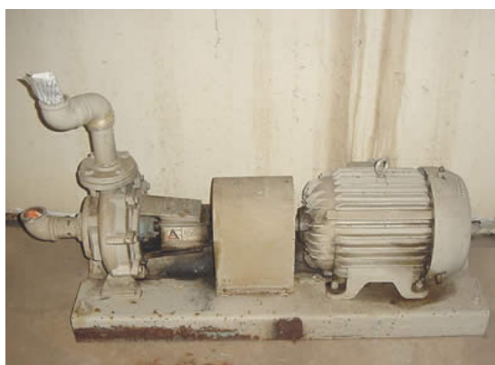
شکل ۶-۱۱-۳- یک پمپ سانتریفوژ متصل به الکتروموتور
