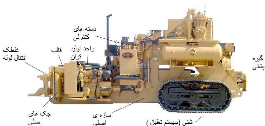
شکل ۴- اجزای اصلی یک دستگاه لوله خم کن
