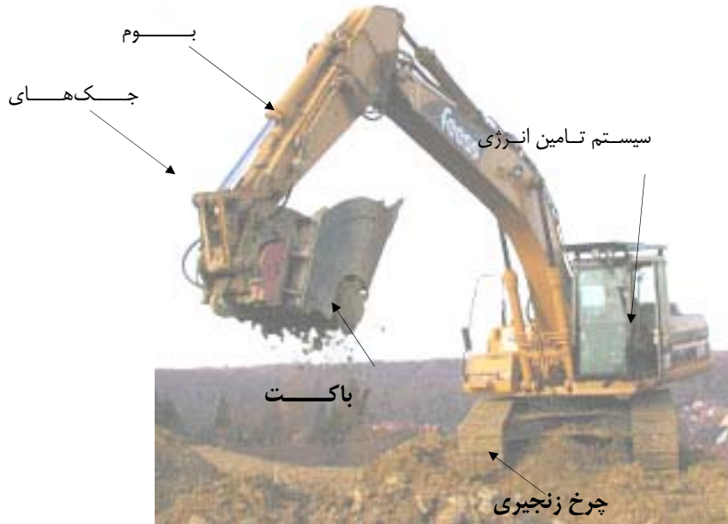
شکل ۳-۵-۷- قسمت‌های اصلی یک دستگاه باکت حفار سنگین
