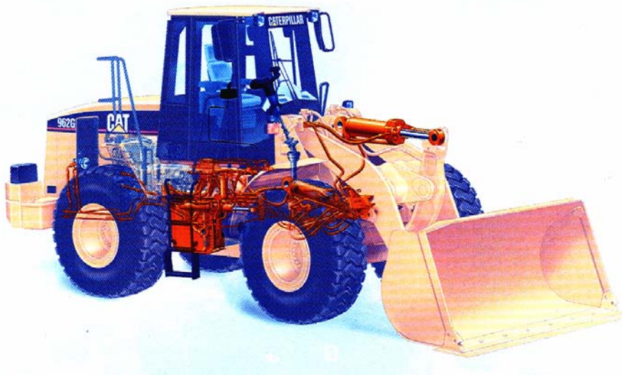
شکل شماره ۲-۱-۳- سیستم هیدرولیک یک نمونه لودر
