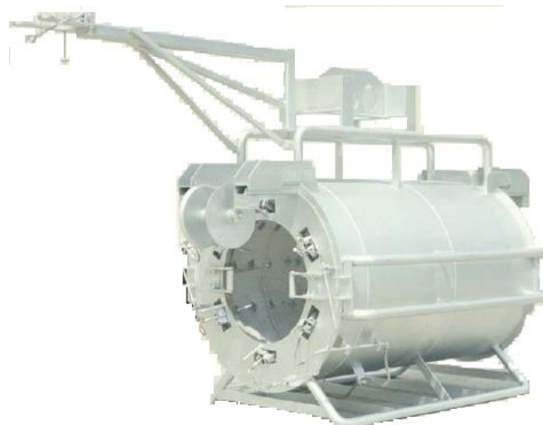
شکل ۱-۳-۵- دستگاه پیش گرمکن لوله
