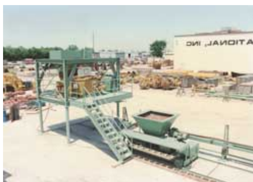
شکل ۵-۴-۱۳- دستگاه پوشش دهی داخلی با ملات سیمان
