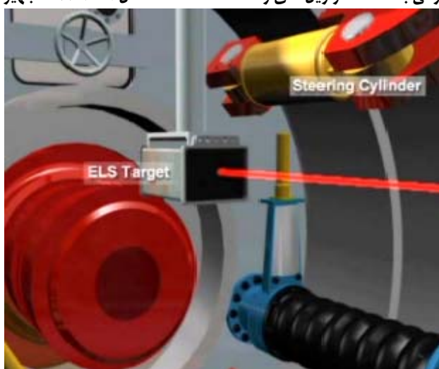
شکل ۹-۶-۱۵- کنترل مسیر توسط اشعه لیزر
