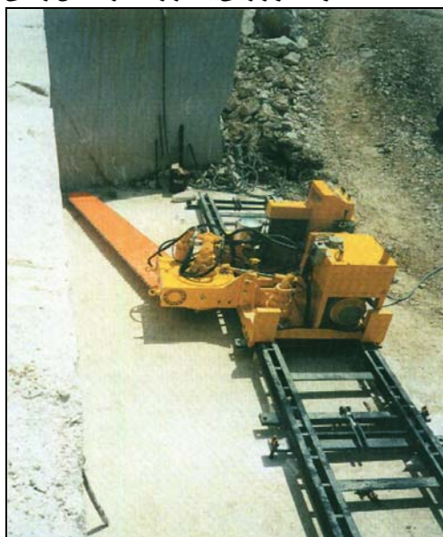
شکل ۳-۲۷-۶- نمونه هاواژ ریلی به کار رفته در معادن سنگ تزئینی و نما
