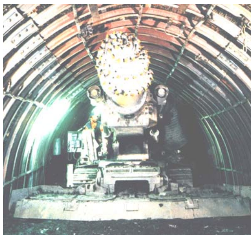
شکل ۳-۱۶-۳- ماشین روده‌در با برش محوری
