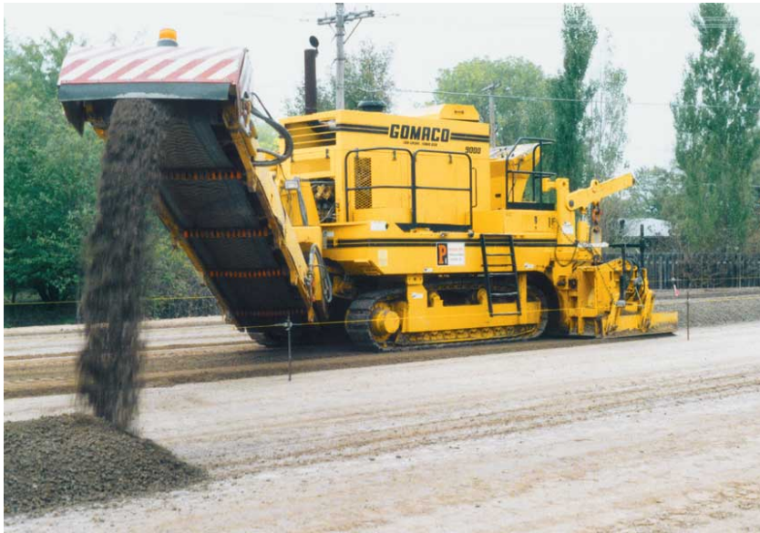
شکل شماره ۲-۱۸-۳- تسمه نقاله تریمر آسفالتی
