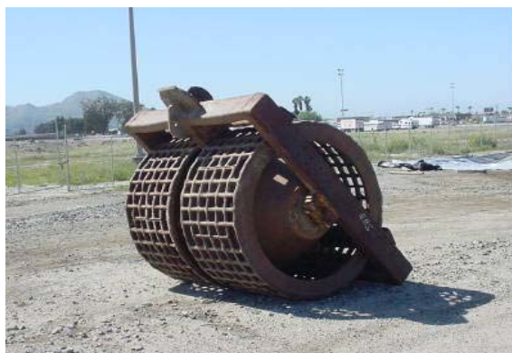
شکل شماره ۲-۴-۲- استوانه شبکه‌ای که با استفاده از تراکتور عمل تراکم خاک را انجام می‌دهد.
