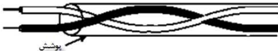
شکل 2-13 زوج سیم به هم تابیده شیلد دار
