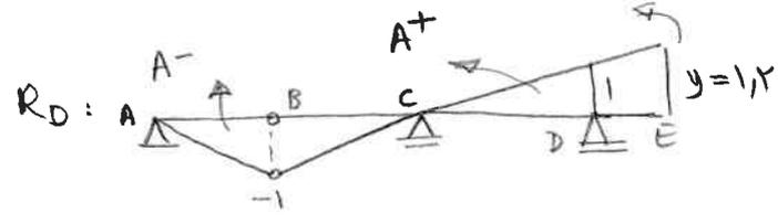
بیشترین عکس العمل در نقطه A است که بار از A بین C و B است بیشترین عکس العمل کسبی هنگام است که بار نزدیک به A, C است
