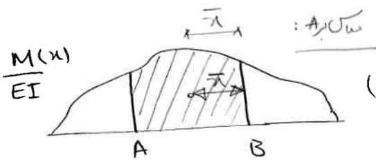
مساحت:  $\frac{M}{EI}$  (در فاصله B تا A)  $\frac{M}{EI}$   $\bar{x}$  فاصله عمود از سطح عمود
