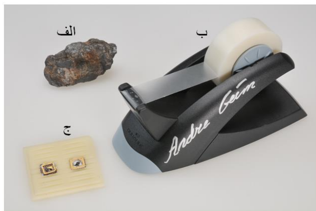
الف) یک کلوخه از گرافیت، ب) چسب و ج) یک ترانزیستور گرافن
