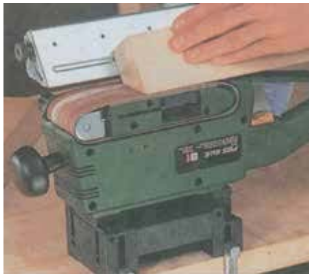
شکل ۹-۱۴- با استفاده از تکیه‌گاه قابل تنظیم می‌توان چوب‌ها را تحت هر زاویه به وسیله‌ی ماشین سنباده نواری پرداخت کنید.
