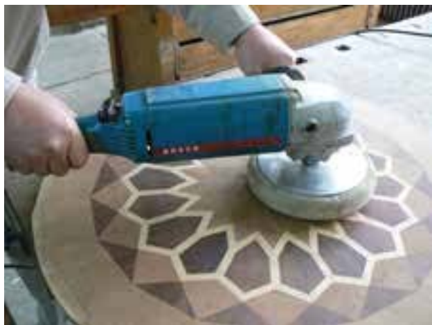
شکل ۲۰-۹- ماشین سنباده دیسکی را می‌توانید به‌عنوان پولیش‌کاری در رنگ‌های پولیستر به‌کار ببرید.
