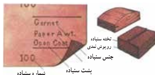
شکل ۹-۴- نحوه‌ی بستن کاغذ سنباذه به دور یک قطعه تخته
