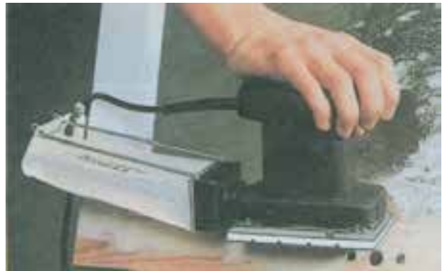
شکل ۳۶-۹- به وسیله‌ی ماشین‌های سنباده لرزشی کوچک (مشتی) می‌توانید سطوح کوچک را جهت آستری و رنگ‌کاری سنباده‌کاری کنید.
