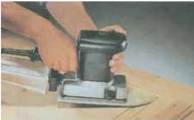
شکل ۳۷-۹- سطوح قاب‌های ساخته شده را می‌توانید به وسیله‌ی ماشین سنباده لرزشی جهت آماده‌سازی آن‌ها برای رنگ‌کاری، سنباده‌کاری کنید.
