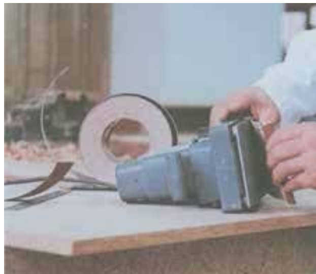
شکل ۲۸-۹- نحوه‌ی تعویض کاغذ سنباده ماشین لرزشی که پس از بریدن کاغذ سنباده ابتدا و انتهای آن را بین دو گیره عقب و جلو صفحه کف ماشین قرار دهید.
