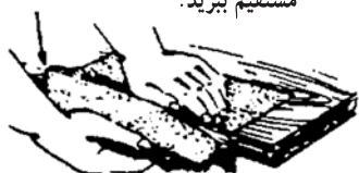
شکل ۹-۷- نحوه‌ی عمل قطع کردن سنباذه، سنباذه کاری باید در جهت الیاف چوب باشد.
