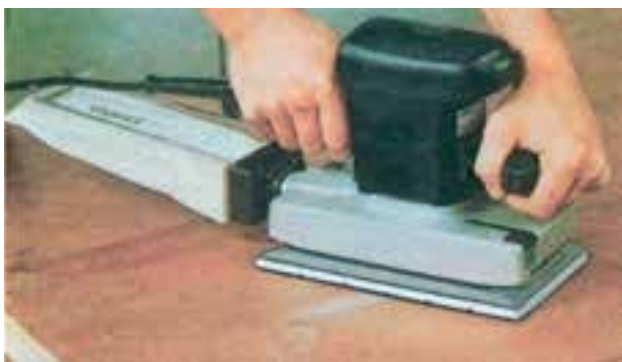
شکل ۹-۳۵- ماشین سنباده باید به طور یکنواخت روی سطح کار حرکت داده شود.
