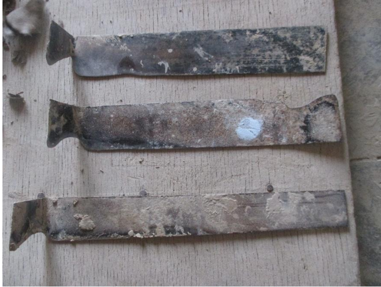
تصویر 2: رنده برای صاف کردن سطح سفال
