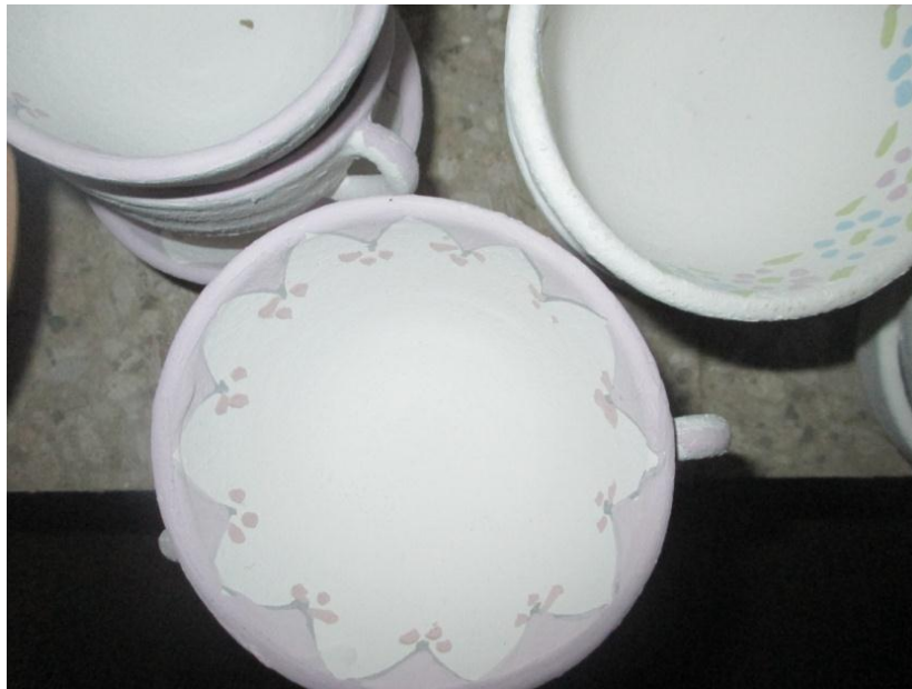
تصویر 9: سفال‌هایی که پس از پخت اول با رنگ‌های لعاب نقاشی شده‌اند. پس از آن لعاب شفاف شیشه‌ای زده شده و آماده رفتن به کوره هستند.
