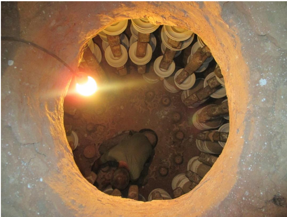
تصویر 29: نمونه یک کوره زیر زمینی در کارگاه آقایان امیری
