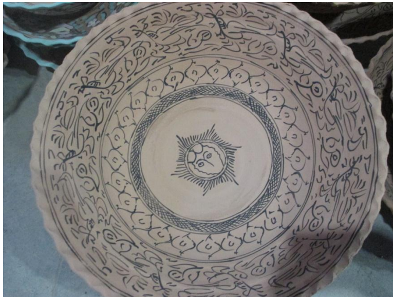
تصویر 7: سفالی که پس از پخت بیسکویت با رنگ سیاه قلمگیری شده است.
