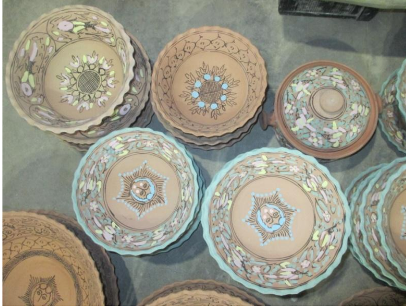
تصویر 8: سفال‌هایی که پس از پخت اول با رنگ‌های لعاب نقاشی شده‌اند و هنوز لعاب شفاف شیشه‌ای زده نشده‌اند.
