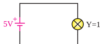
شکل ۳-۳. ب) مدار معادل اثر یک در عمل جمع منطقی (OR)
