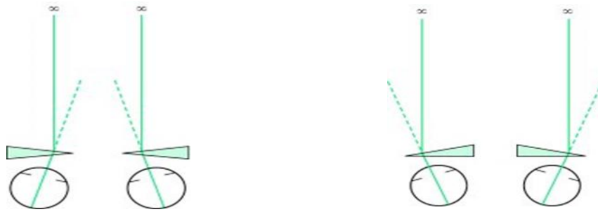
شکل ۱-۱۶: چگونگی تصحیح اگزوفوریا و ایزوتروپیا با استفاده از منشور
