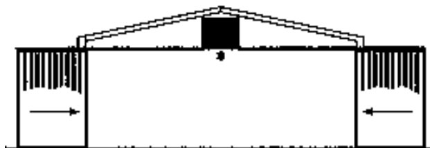
شکل ۱-۳ باز شدن در توسط بازوهای خارج دیوار
