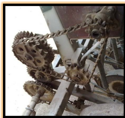
شکل ۱۰- چرخ دنده های انتقال قدرت در خطی کار که از چرخ محرک انتهایی نیرو می گیرند.
