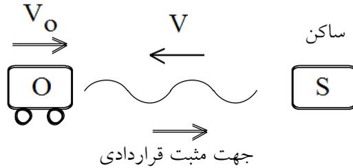
$$\frac{v_{o1}}{(-V) - (+V_o)} = \frac{v_s}{(-V) - 0} \Rightarrow \frac{v_{o1}}{V + V_o} = \frac{v_s}{V} \Rightarrow v_{o1} = \frac{V + V_o}{V} v_s > v_s$$
