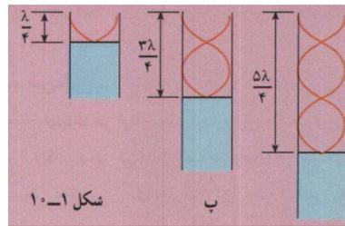
در این حالت با کاهش سطح آب از طریق شیر کنترل خروج آب که در انتهای لوله قرار دارد می‌توان موج ایستاده درست کرد.
