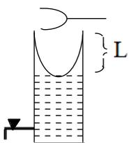
مانند شکل، یک لوله را از آب پر نموده و یک دیافراگم با بسامد معلوم  $\nu$  را بالای آن به نوسان درمی‌آوریم. آن‌گاه شیر آب را باز می‌کنیم تا سطح آب در لوله پایین آید. هنگامی که برای اولین بار پدیده تشدید صورت گرفت، شیر آب را می‌بندیم.
