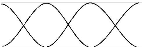
مانند شکل، در یک لوله‌ی صوتی با دو انتهای باز به طول ۲۴ cm موج ایستاده‌ای تشکیل شده است. با توجه به اطلاعات داده شده به سه سؤال زیر پاسخ دهید.
