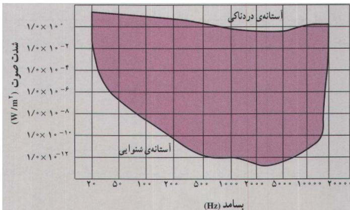
۶- با استفاده از نمودار زیر تعیین کنید که آستانه‌ی شنوایی و دردناکی در بسامد  $10,000$  هرتز تقریباً چقدر است.
