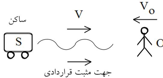
$$\frac{\nu_0}{(+V) - (-V_0)} = \frac{\nu_s}{(+V) - 0} \Rightarrow \frac{\nu_0}{V + V_0} = \frac{\nu_s}{V} \Rightarrow \frac{\nu_0}{V + \eta V} = \frac{\nu_s}{V} \Rightarrow \nu_0 = (1 + \eta) \nu_s$$
