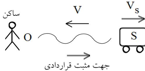
$$\frac{v_{O2}}{(-V) - 0} = \frac{v_s}{(-V) - (+V_s)} \Rightarrow \frac{v_{O2}}{V} = \frac{v_s}{V + V_s} \Rightarrow v_{O2} = \frac{V}{V + V_s} v_s < v_s$$
