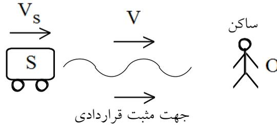
$$\frac{v_{O1}}{(+V) - 0} = \frac{v_s}{(+V) - (+V_s)} \Rightarrow \frac{v_{O1}}{V} = \frac{v_s}{V - V_s} \Rightarrow v_{O1} = \frac{V}{V - V_s} v_s > v_s$$
