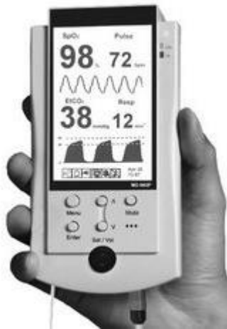
شکل ۱۳۰- دستگاه کاپنوگراف جهت اندازه‌گیری میزان دی‌اکسی کربن بازدمی
