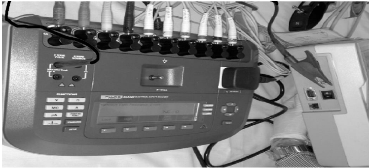
شکل ۱۵۹- آزمون ایمنی الکتریکی دستگاه الکتروکاردیوگراف
