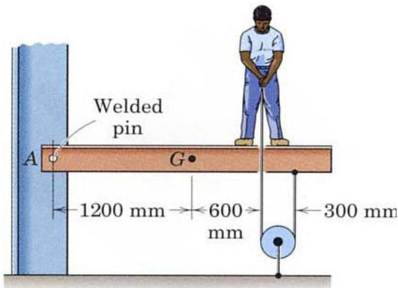
۱. تیر فولادی شکل زیر را با پین A به ستون متصل کرده اند و سپس پین را هم به ستون جوش داده اند. جرم تیر ۲۰۰ کیلو گرم است و مرکز جرم آن در نقطه G قرار دارد. برای آزمودن جوش، شخصی به جرم ۸۰ کیلو گرم طنابی را که مطابق شکل از سوراخ داخل تیر عبور کرده است با نیروی ۳۰۰ نیوتن می کشد. گشتاوری را که بر پین وارد می شود بدست آورید. (نمره ۱/۵)
