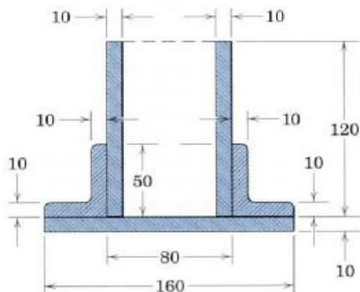
۴. در شکل روبرو مقطع یک قطعه ساختمانی نشان داده شده است. این قطعه متشکل از چند قطعه مختلف است. مرکز سطح این قطعه مرکب را بدست آورید. ابعاد داده روی شکل به میلیمتر هستند. (نمره: ۲)
